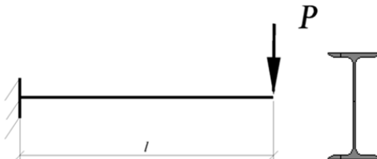
Рис. 121. Расчетная схема балки
