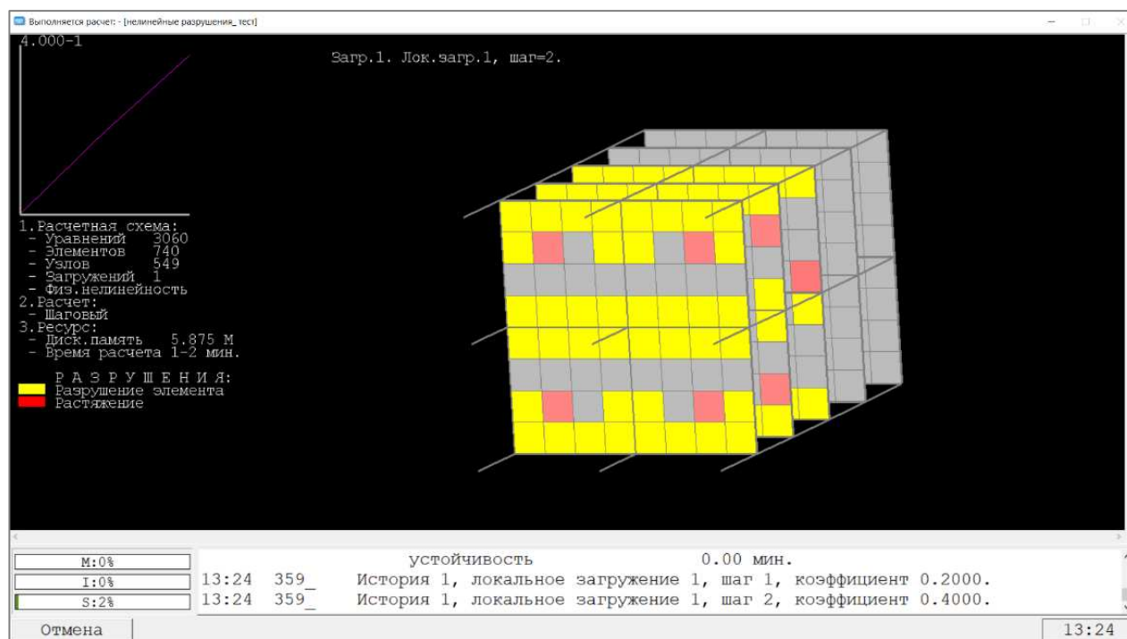
Рис. 11.10 Индикация разрушений в элементах во время расчета
